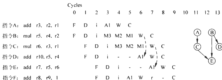
图 1.15 程序在乱序执行的超标量流水线中的执行情况
